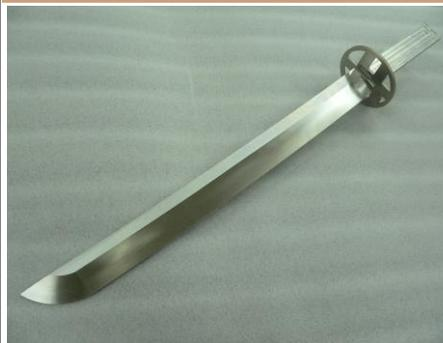
こちらのワークは、12月2日から5日にかけてインドネシアの展示会で展示した模造刀です。このワークの材質はハステロイで、ワークサイズは 12×60×500 です。ハステロイは耐熱性、耐食性に優れた材料で、加工を施した際に加工硬化が生じやすい為、加工が極めて困難な材料の1つです。またこの模造刀は、両サイドが斜めになっているため、クランプがしにくい形状となっています。そのため、治具を用いてクランプした後に加工することで、模造刀の先端の平行度 0.1 を実現することが可能となりました。城陽富士工業では、ハステロイだけでなくインコネル、インバーなどの難削材加工にも対応しています。難削材加工でお困りの際は城陽富士工業にお問い合わせください。
