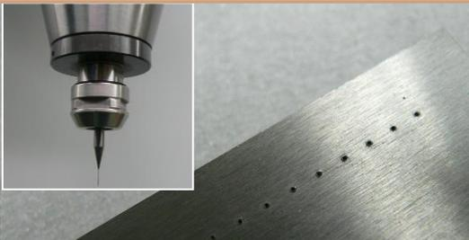
材質 SUS304 において、Φ0.3mm、深さ6mmの加工に成功しました。今まで弊社では細穴加工はジグボアで加工していましたが、ジグボアは他の精密加工にも使用する為、細穴加工の短納期や量産への対応が困難でした。そこで、今回は他のマシニングセンターに高速スピンドルを装着して細穴加工に成功しました。他のマシニングセンターでの加工が可能になったので、生産性を上げることができました。細穴加工の事なら城陽富士工業にお任せ下さい。
