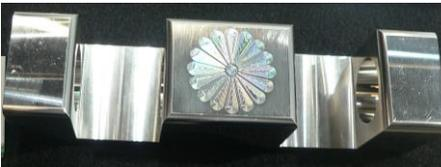
難削材であるインバーに深穴ボーリング加工を行ったものです。マシニングセンター(DuraVertical5060)によって段落ち加工を行った後、横型マシニングセンター(HS5A)により、側面に深穴荒加工後に仕上げ加工を行い、さらにφ32H7の深穴ボーリング加工を施しました。この深穴ボーリングは底面に対しての平行度10μm、同芯度10μmに仕上げています。スーパーインバーは熱による体積の膨張が少ない(鉄の熱膨張係数の1/100以下)ため、航空宇宙、医療、地震活動検出器等の部品に適しています。ただし、加工が容易ではない難削材として知られています。このような難削材スーパーインバーでお困りのお客様は、城陽富士工業にお任せください！
