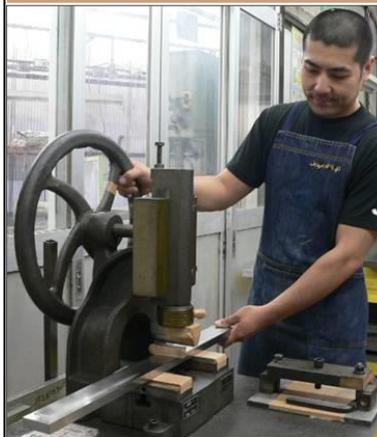
こちらのワークは、材質が S50C で、ワークサイズが 8mm×37mm×1,266mm の長尺薄物プレートで、加工精度は平面度 0.1 を歪取り作業により出しています。城陽富士工業では、長尺部品の加工を得意としていますが、加工の際にネックになるのが、加工時にワークに歪やねじれなどが発生し、精度が外れることがあることです。一般的に機械加工で加工精度を出すことが最適とされていますが、歪取りが必要なワークの数が多い場合には、加工時間やコスト面の事も考慮して、弊社では歪取り作業を行うことで精度を出す場合もあります。長尺薄物加工でお困りの際には、是非一度、城陽富士工業までご連絡下さい。ワークへの VA・VE 提案も致します。
