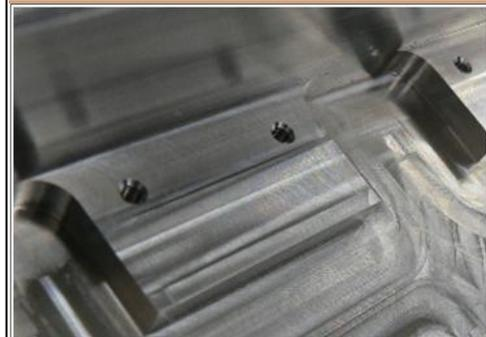
次にご紹介させていただきます加工事例は、複雑加工が施された SUS316 製の長尺部品です。この部品には、深い掘り込みの奥に段がある形状をしています。このような形状の場合、バリが出ると面取りを行う際に工具を入れるためのスペースを確保できなかったり、手作業でもあってもバリ取りを行うことが困難となったりする場合があります。弊社では、このようなバリ取りを行いにくい形状の部品を加工する際には、できるだけバリの出ないようカッターパスを考えて加工しております。今回ご紹介したような複雑部品の加工も城陽富士工業まで一度ご連絡ください。
