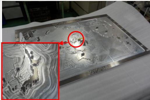
左の写真は先月行われた京都ビジネス交流フェア出展品のアルミで作成した世界地図です。作成にあたっては、画像データをCADデータに変換した上、詳細かつ立体的に再現することにこだわりました。φ0.3mmのエンドミルを使用して日本列島など細部に渡って精密な加工を施したことに加え、このような大きなアルミプレートでも歪みを極限まで抑えて作成したことが特長です。城陽富士工業はこのようなプレートの製作を得意としておりますのでぜひお声掛け下さい。
